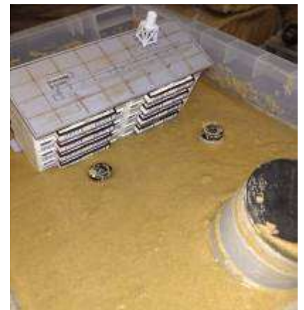
えきじょうかげんしょう もぎじっけん 液状化現象の模擬実験
